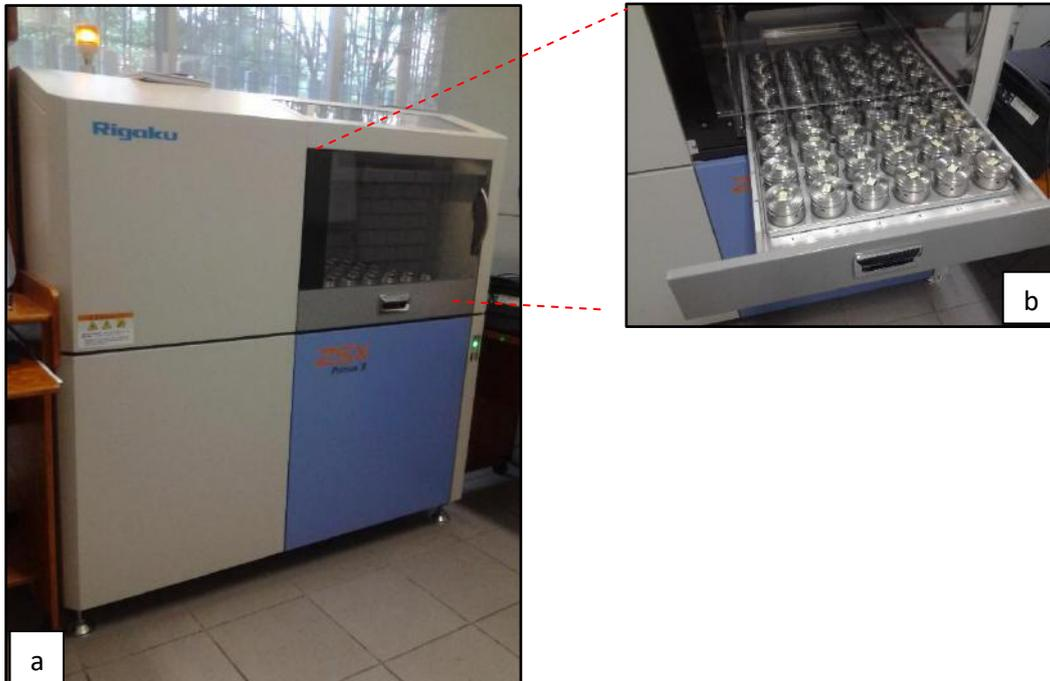
Figura 4.6. a) Espectrómetro de Fluorescencia de Rayos X tipo Rigaku. b) Acercamiento de las muestras una vez montadas en el equipo.
