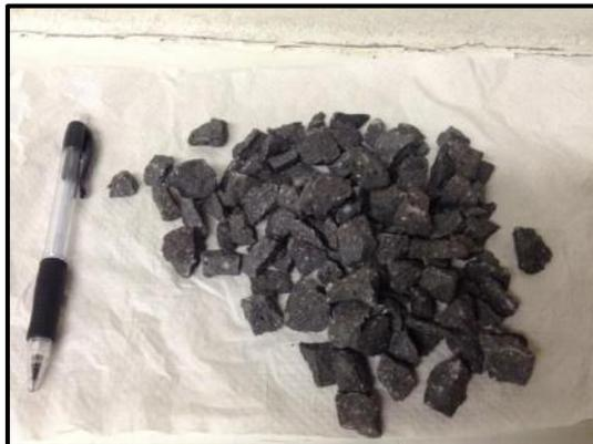
Figura 4.1. Muestra de la roca partida en fragmentos de ~2 cm previo a su lavado y molienda.
