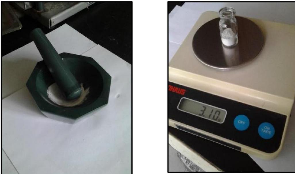
Figura 4.10. a) Pulverización de la muestra en un mortero de ágata hasta obtener un tamaño de partículas similar al talco. b) Muestra colocada en un frasco de vidrio y pesada.
