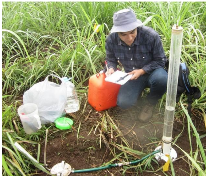
Figura 8. Realización de los ensayos de infiltración.
