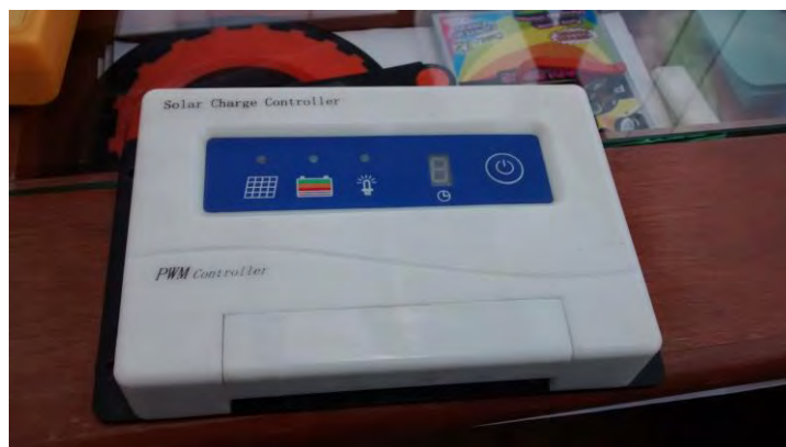
Imagen 7 Controlador solar MASS POWER
