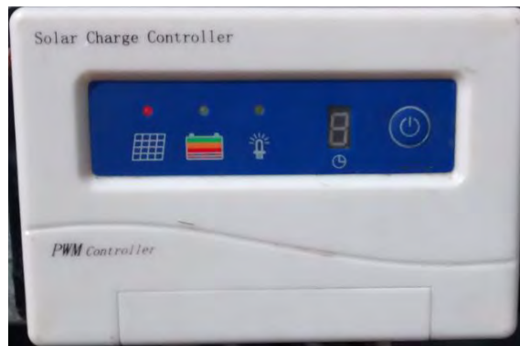
Imagen IV.3: Controlador de carga solar
