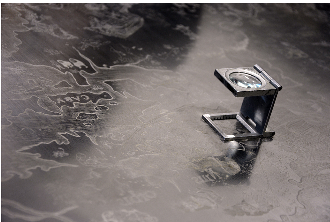
Figure 1.8: Se utiliza un cuentahílos para observar a detalle la profundidad de línea atacada.
