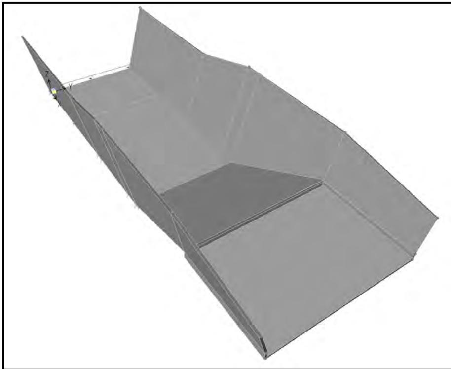
Figura 3.20 Vista desde margen derecha del tanque amortiguador
