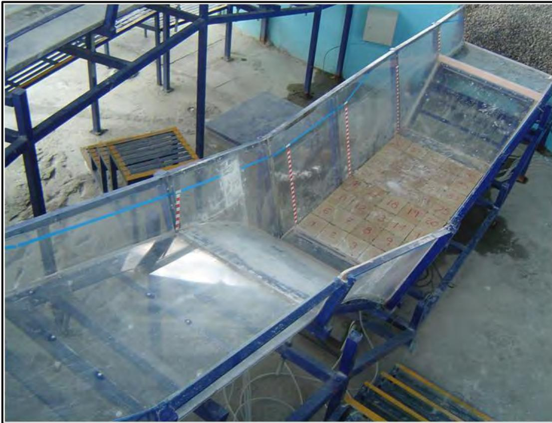
*Figura 3.30 Acomodo de las losas escaladas en el modelo
