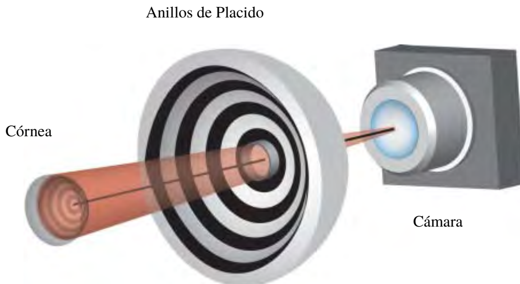
Figura 1.4 Esquema de un topógrafo con anillos de Placido, tomada de [3]. La imagen virtual que se forma detrás de la córnea es capturada con una cámara que se encuentra al otro lado del topógrafo.
