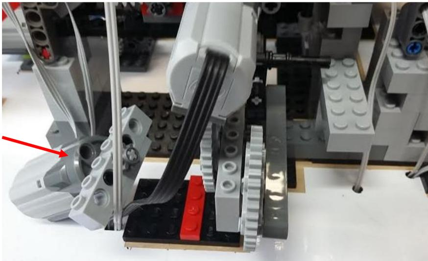
Figura 4. 11. Motor 2 de mecanismo separador desacoplado.
