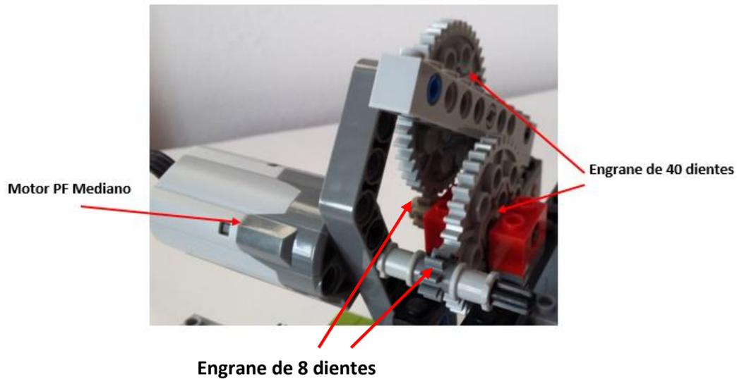
Figura 3. 1. Reductor de velocidad con engranes paralelos.
