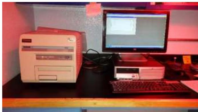
Figura 3.1. Equipo Harshaw TLD 3500 acoplado al programa WinREMS®
