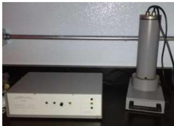
3.2. Equipo SUERC PSL utilizado para la detección del alimento irradiado.
