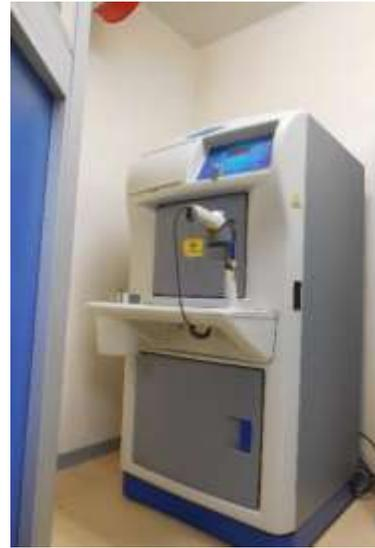
Figura 3.3. Irradiadores de fuentes gamma. **a)** Irradiador semi industrial Gammabeam 651 PT de alberca profunda utilizado para la irradiación a dosis altas de las muestras de cascarón blanco y rojo con  $^{60}\text{Co}$  (Fuente: Diversos usos de la fuente de rayos gamma en la UNAM (Epifanio Cruz-Zaragoza, 1997)). **b)** El nuevo irradiador Gammacell-3000 Elan de  $^{137}\text{Cs}$  utilizado para irradiar las muestras a dosis bajas.
