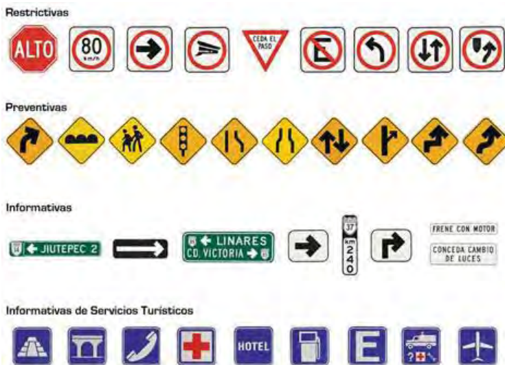
Figura 4.1 | Ejemplo del Señalamiento Vertical (Fuente: Normativa SCT)
