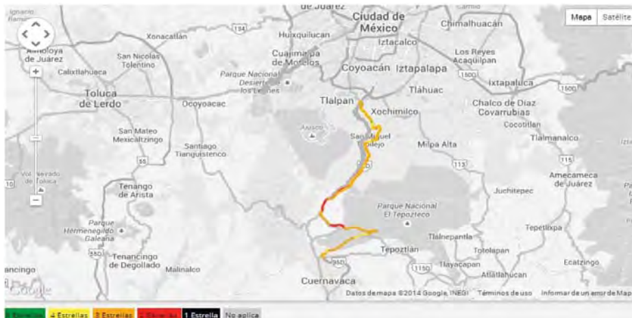
Figura 4.13 | Calificación por Estrellas de la Autopista México – Cuernavaca cuerpo A (Fuente: Banco de datos de auscultación volúmenes de tránsito y seguridad vial SCT)
