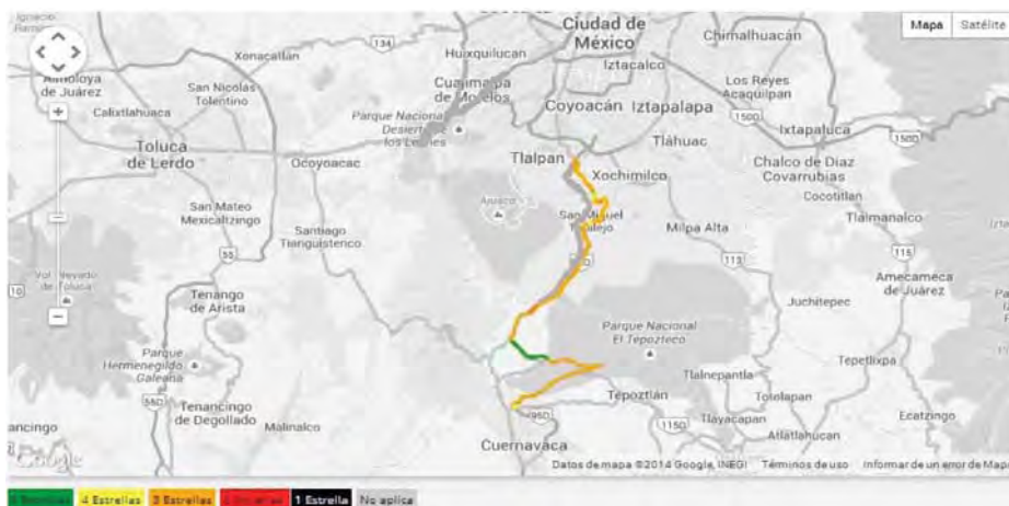
Figura 4.14 | Calificación por Estrellas de la Autopista México – Cuernavaca cuerpo B (Fuente: Banco de datos de auscultación volúmenes de tránsito y seguridad vial SCT)
