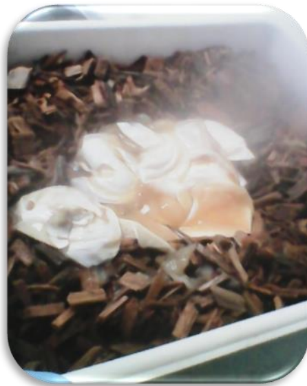
Figura 4.8 Inoculación del hongo Trametes versicolor en el medio filtrante
