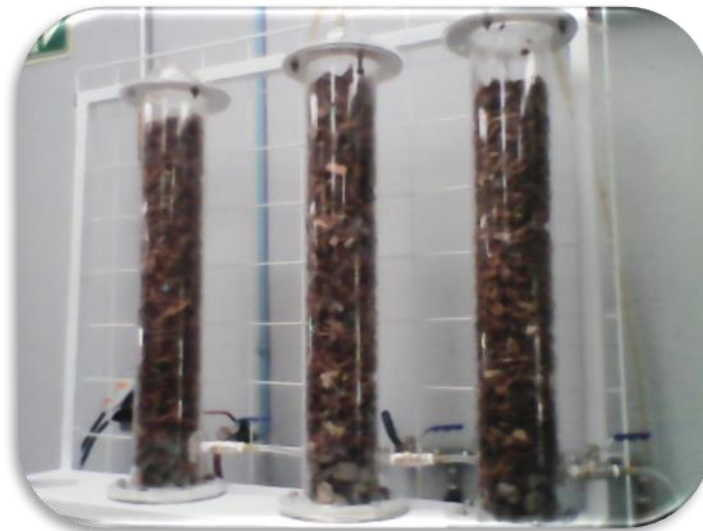
Figura 4.10 Sistema de biofiltración fúngica
