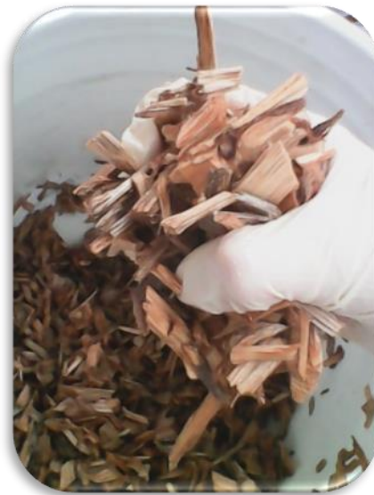
Figura 4.6 Medio filtrante humedecido al 65%
