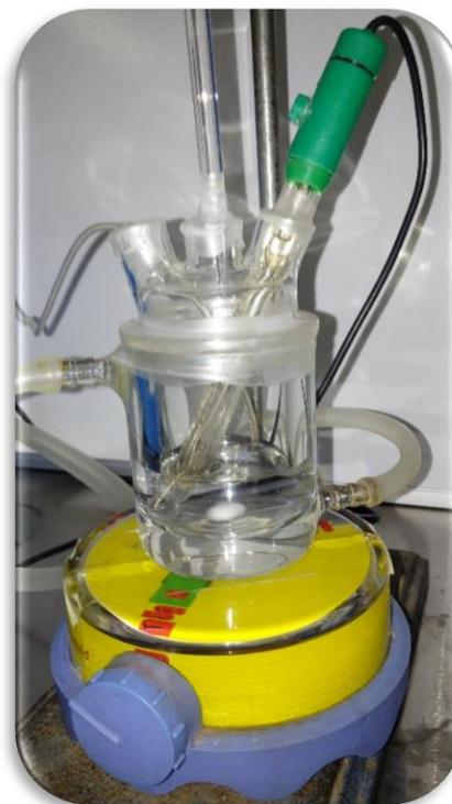
**Imagen 16. Montaje experimental de la valoración espectrofotométrica.**
