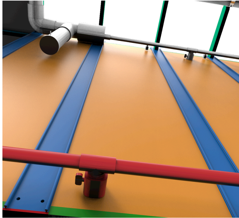
Fig. 50. Vista a contrapicada de la Caseta de almacenamiento; se aprecia la manera en la que están interconectadas las Cisternas flexibles.
