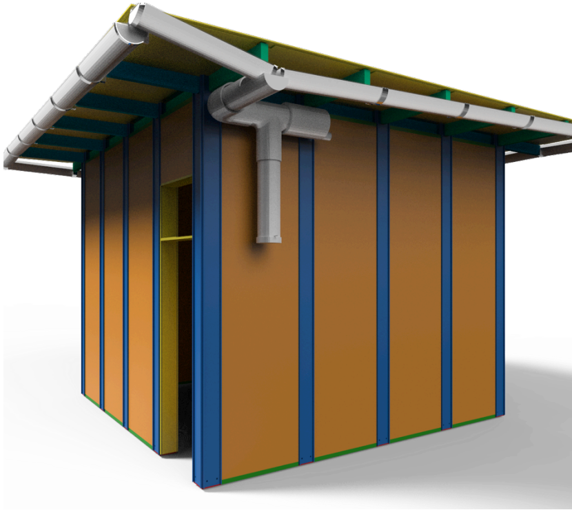
Fig. 25. Instalación del Separador de primeras aguas.
