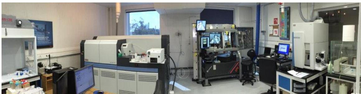
Figura 2.2. Espectrómetro de masas con plasma acoplado por inducción con multicolector (ICP-MS-MS) Thermo Neptune Plus a la derecha, espectrómetro de masas cuadrupolar con plasma acoplado por inducción (ICP-MS) Thermo XSeries-ii a la izquierda de la fotografía, y sistema de ablación láser Resonetics Resolution M-50 en el centro, pertenecientes al laboratorio de estudios isotópicos del Centro de Geociencias de la UNAM.
