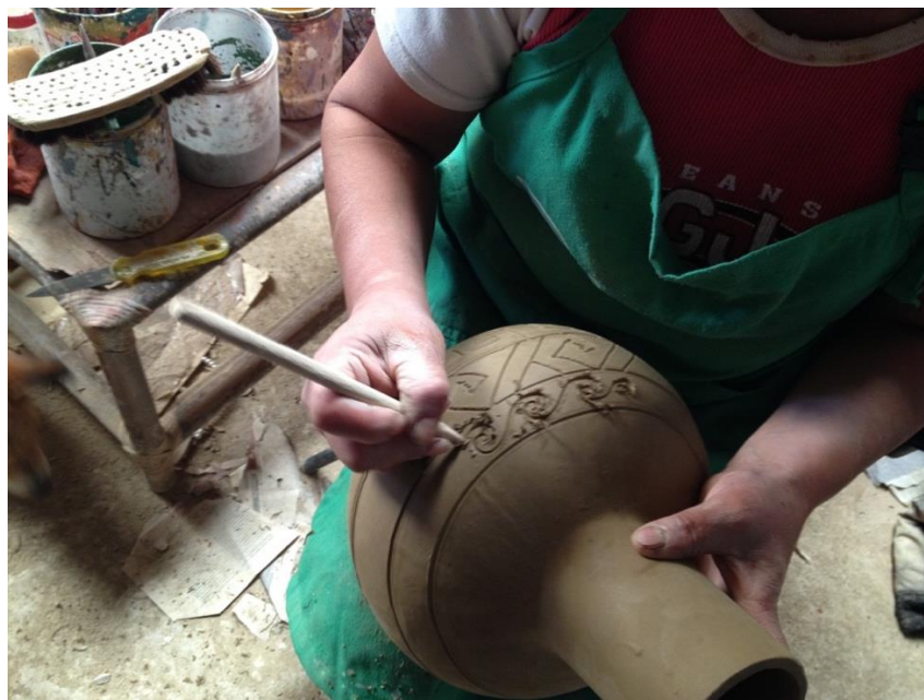
Figura 113. Artesana realizando la decoración utilizando un punzon de madera. San Miguel del Milagro, Nativitas, Tlaxcala.
