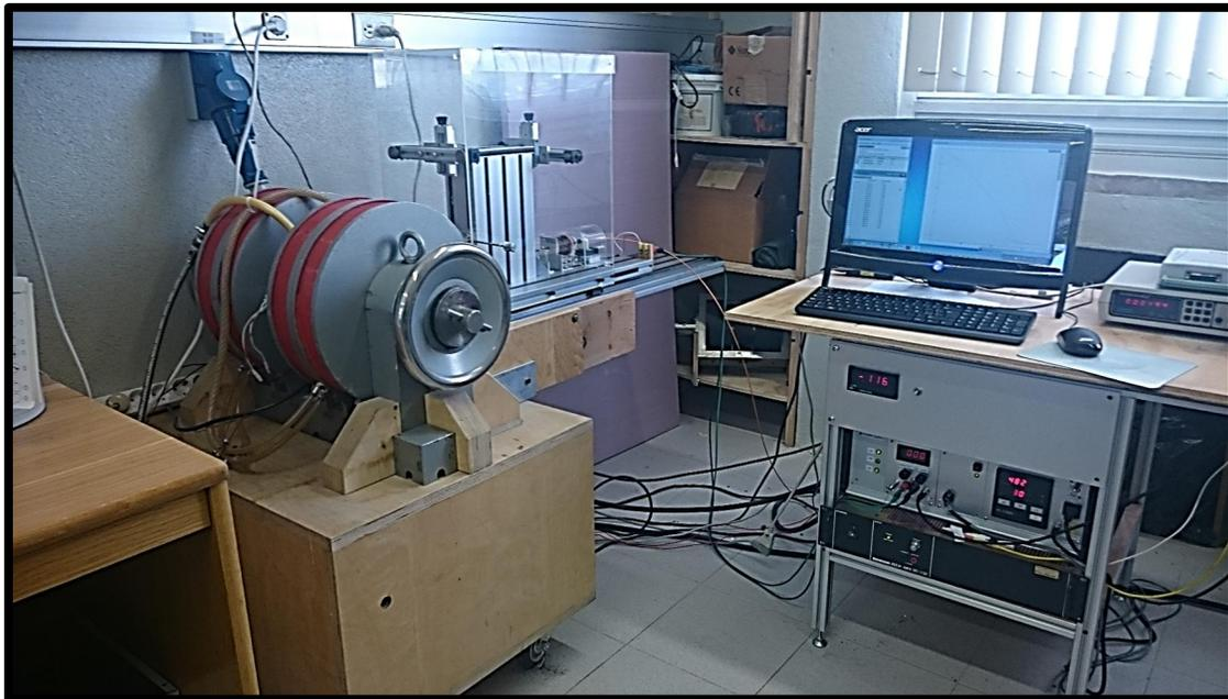
Figura 4.6. Balanza de Curie y sistema de cómputo utilizado.
