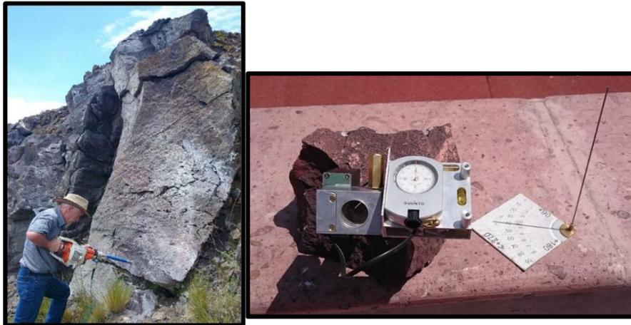
Figura 4.1. Obtención de núcleos y equipo para orientar los núcleos antes de extraerlos.
