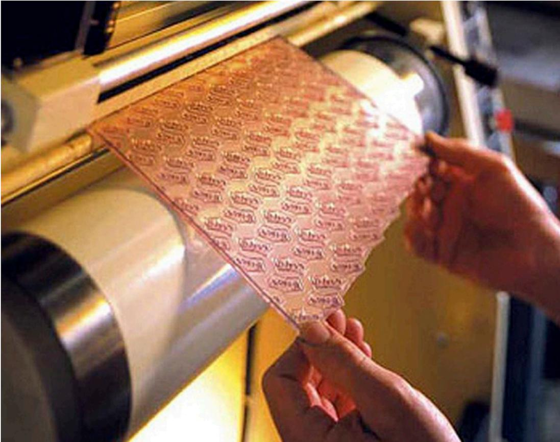
**Figura 7 Ejemplo de plancha flexográfica**
