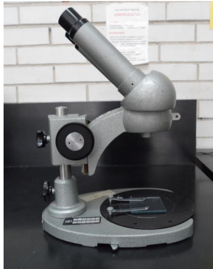
Fig. 15 Microscopio óptico para observar las líneas impresionadas de cada muestra. Fuente Directa
