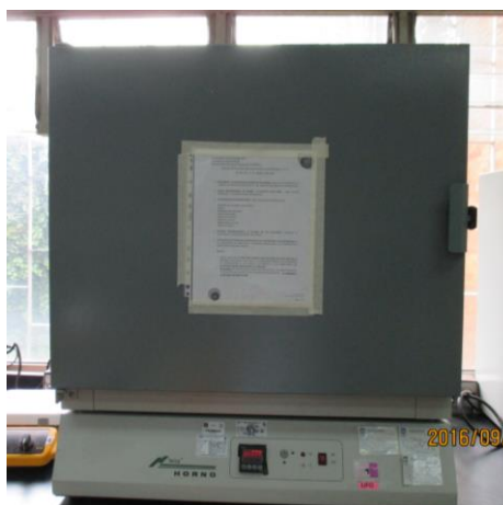
Fig. 10 Estufa de temperatura controlada a 37°C. Fuente Directa
