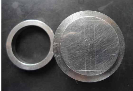
Fig. 2 Patrón metálico vista superior se observan las tres líneas verticales de 75, 20 y 50 micras y dos líneas horizontales de 75 micras. Fuente Directa
