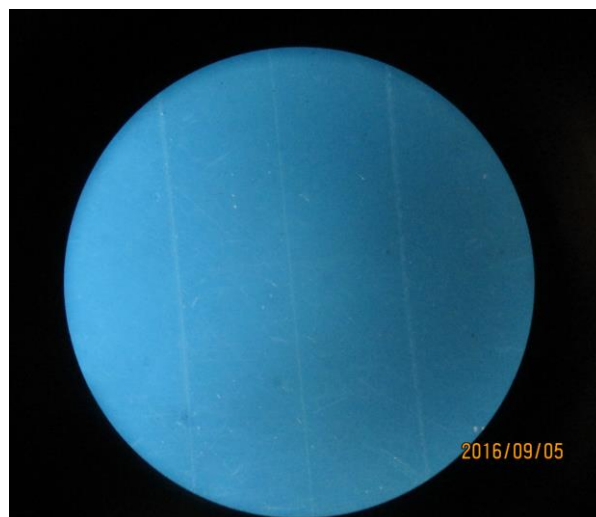
Fig. 16 Vista microscópica de las tres líneas impresionadas a 75, 20 y 50 micras. Fuente Directa
