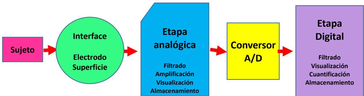
**Figura 21. Sistema de adquisición de Señales Bioeléctricas**
