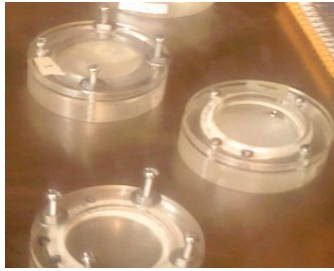
Figura 16. Sistema hermético para armar las celdas.
