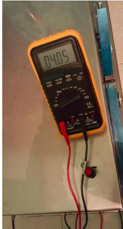
**Figura 77.** Toma inicial de corriente con carga cero.
