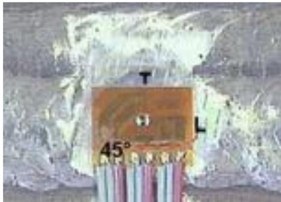
**Figura 13.** Imagen de una galga extensométrico pegada a una superficie metálica.
