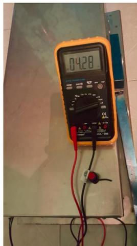
**Figura 79.** Corriente consumida durante la prueba 1
