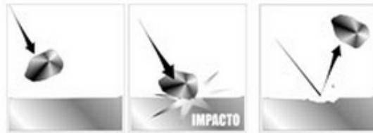
**Figura 22.** Desgaste erosivo.
