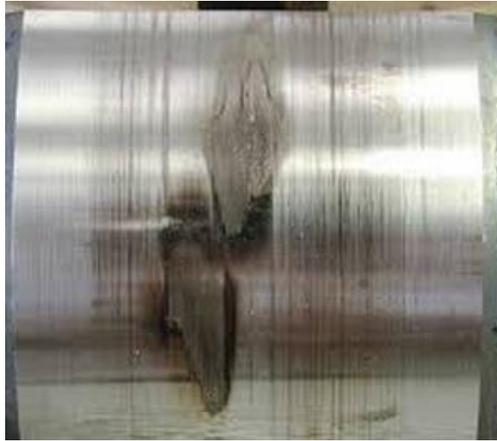
**Figura 24.** Ejemplo de desgaste por deslizamiento.
