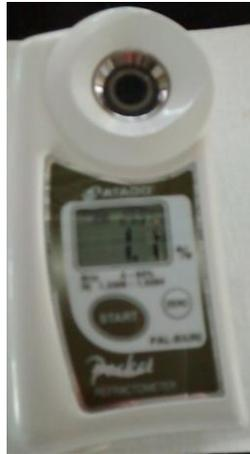
Figura 23. Refractómetro digital (Atago Pal-BX/RI)
