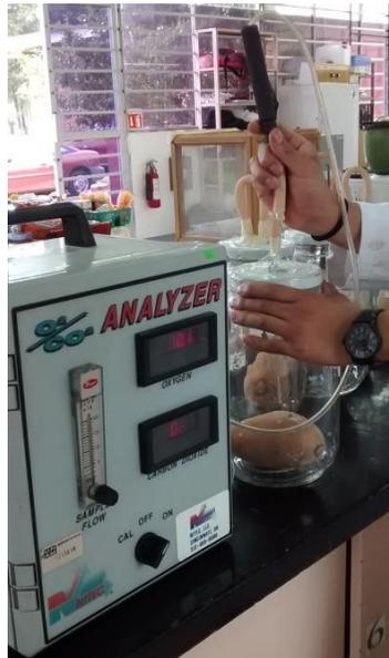
Figura 26. Analizador de gases y forma de medir el  $\text{CO}_2$  producido
