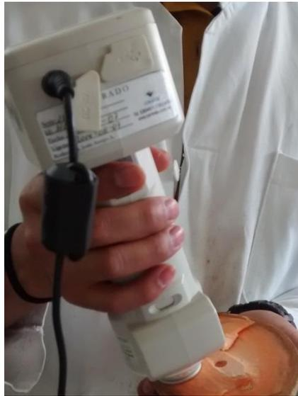
Figura 25. Colorímetro Konica Minolta modelo CM – 600D y medición.
