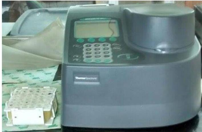
Figura 21. Espectrofotómetro Thermo Spectronic (Genesys 10 UV) usado para la determinación de carotenos
