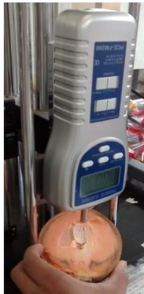
Figura 22. Penetrómetro usado para determinar firmeza
