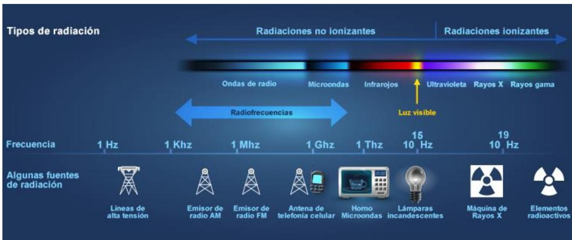
Figura 9. Espectro electromagnético
