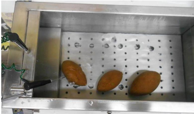
Figura 16. Arreglo de termopares para pruebas preliminares.
