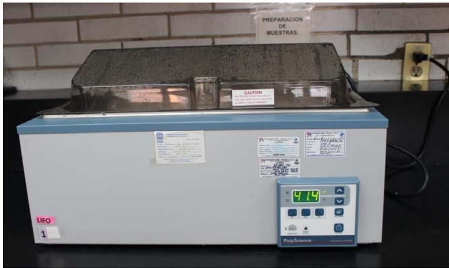
**Imagen propia Fig. 5. Cámara de temperatura controlada POLYSCIENCE**
