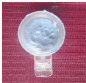
Fig. 5 Mezcla de yeso en el molde plástico.
