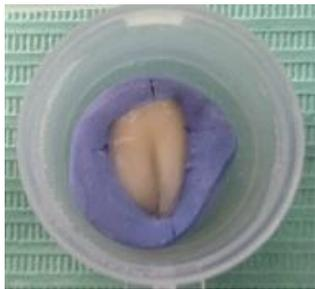
Fig. 12 Muestra montada en yeso tipo III, almacenada en agua desionizada.
