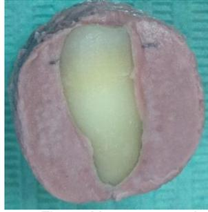
Fig. 36 Muestra montada en yeso tipo IV para determinar la rugosidad inicial (Ra0).
