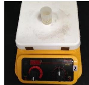
Fig. 35 Disolución del ácido cítrico utilizando un agitador magnético.
