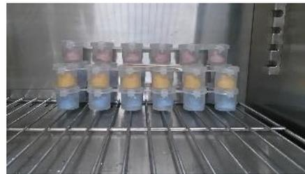
Fig. 10 Muestras dentro de la estufa (37°C).
