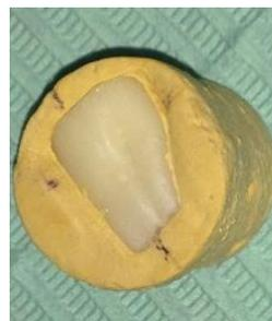
Fig. 26 Muestra montada en yeso tipo III para determinar la rugosidad inicial ( $Ra_0$ ).
