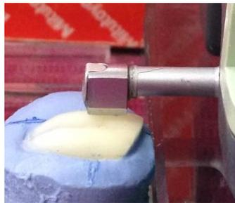
Fig. 13 Se observa el perfilómetro realizando la medición de la superficie radicular.
