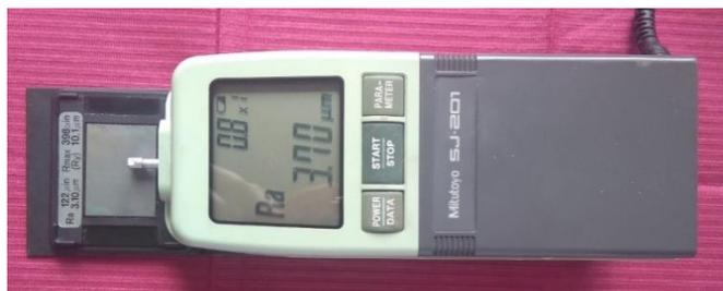
Fig. 7 Perfilómetro.
