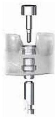
Figura 46 Remoción del tornillo guiado con tornillo.
