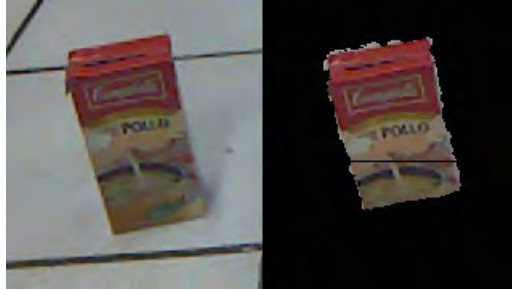
Figura 4.2: Segmentación de un objeto sobre un plano utilizando el algoritmo RANSAC.
