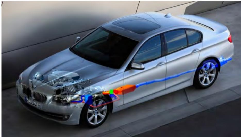
**Figura 5.-** Generador termoeléctrico en escape de automóvil, <http://www.diariomotor.com/>. Consultado Febrero 2015.
