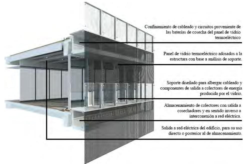
**Figura 12.-** Aplicación del vidrio termoeléctrico bajo las condiciones analizadas, siempre las acciones de viento resultan mayores que las correspondientes al peso de los elementos de la fachada. En el caso de la fachada de piso a techo, los apoyos van directamente a la losa, ©Manuel Alejandro Gutiérrez López.
