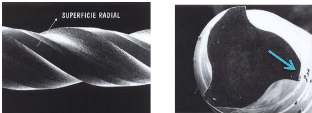
Fig. 12, Superficie radial del instrumento K3 visto transversalmente. 150X. 11
