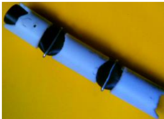
Imagen 3.16.- Ensamble entre falanges y sistema de resorte.
