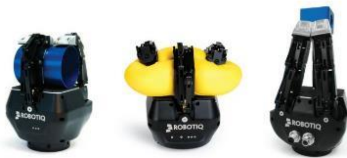
Imagen 1.7.-Gripper de 3 dedos sujetando diferentes objetos. [40]
