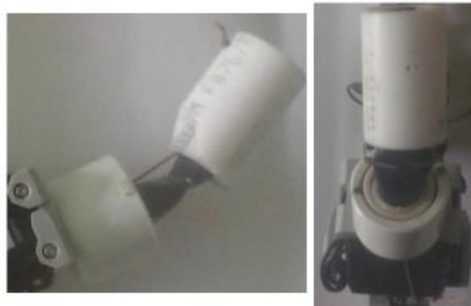
Imagen 3.19.- Pulgar del prototipo. Vistas frontal y lateral.
