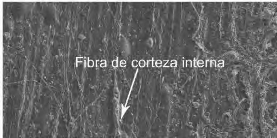
Imagen. 28. Microscopía realizada a la corteza de Pino Radiata. Con el objetivo de analizar el contenido de sus células fibrosas.
