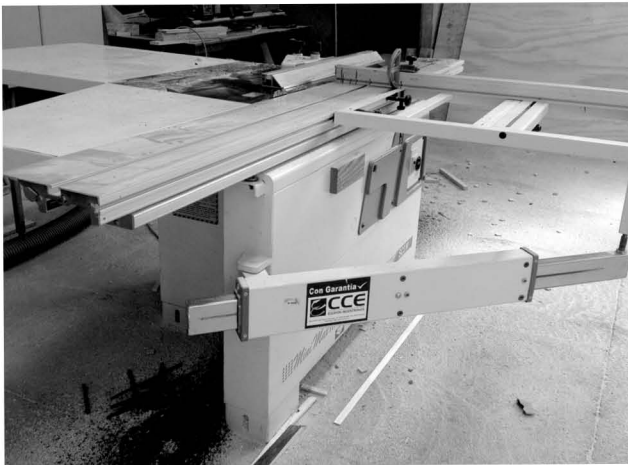
Imagen. 35. Corte de probetas por medio de una sierra escuadradora. Fotografía propia, 2015.
