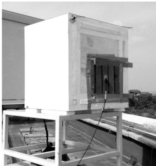
Imagen. 63. Muestra del panel en el módulo de experimentación térmica. Fotografía propia, 2015.
