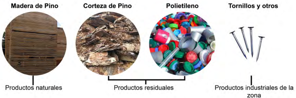
Imagen. 52. Materiales propuestos para el panel de madera. Fotografía propia, 2014.
