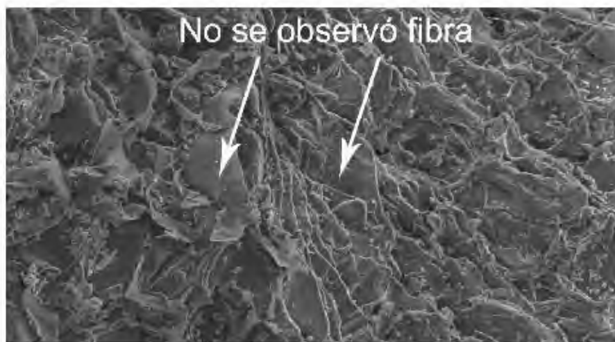
Imagen. 29. Microscopía realizada a la corteza externa de Pino Radiata. Con el objetivo de analizar el contenido de sus células fibrosas.
