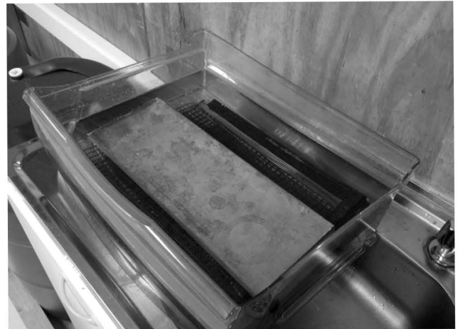
Imagen. 36. Inmersión de probetas, según norma UNE-EN_317. Fotografía propia, 2015.
