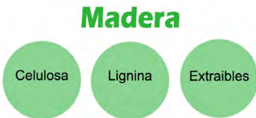
Imagen. 11. Esquema de la composición química de la madera. . Fuente: Manual CONAFOR. Consideraciones tecnológicas en la protección de la madera. Elaboración propia, 2015.
