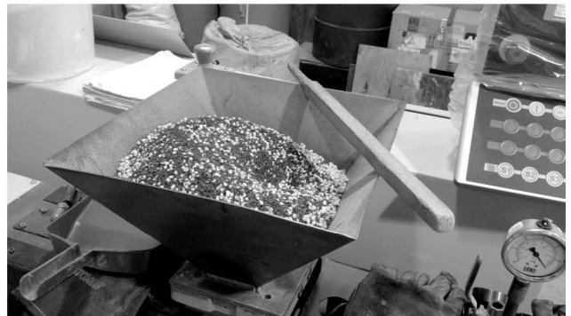
Imagen. Colocación en tolva de extrusora
