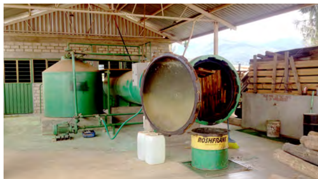
Imagen. 15. Autoclave, por este medio, se aplican materiales oleosos y CCA a la madera.
