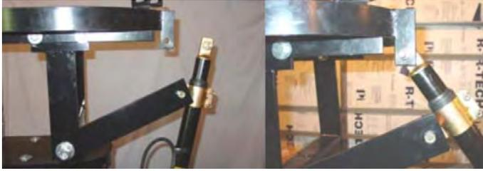
Figura 34: Montaje de las antenas y ensamblado con los motores azimutal y de elevación. Tomado del manual *Assembly Instructions for CASSI Mount* (<http://www.cassicorp.com>).
