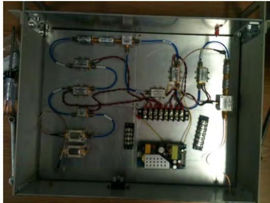
Figura 24: Ensamblado de los componentes que conforman al receptor.
