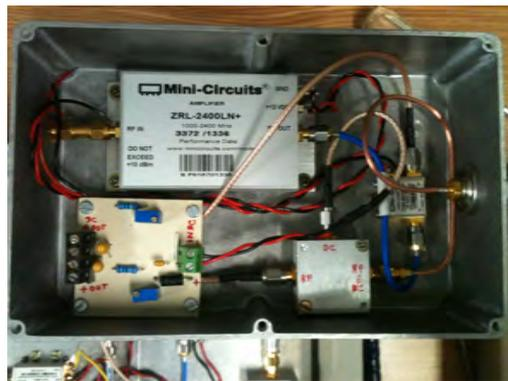
Figura 22: Ensamblado de los componentes que conforman al preamplificador.
