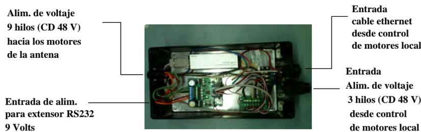
Figura 38: Diagrama de la sección de control remoto de motores.
