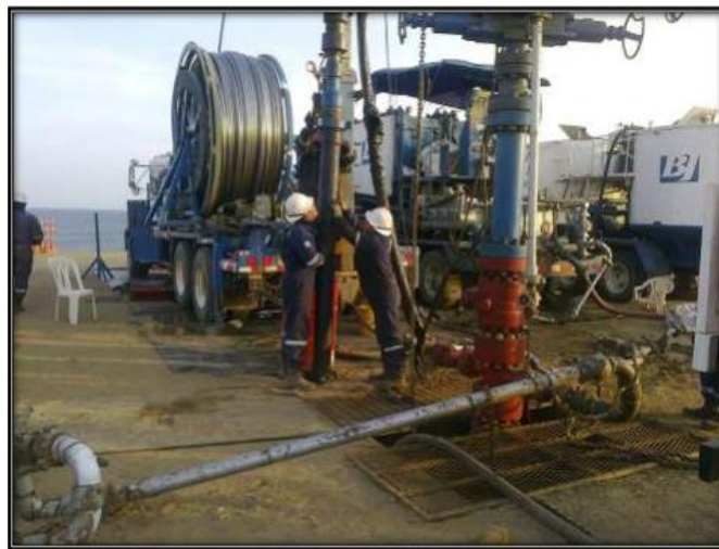
Fig. 2.9 Proceso de fracturamiento con gas y tubería flexible.
