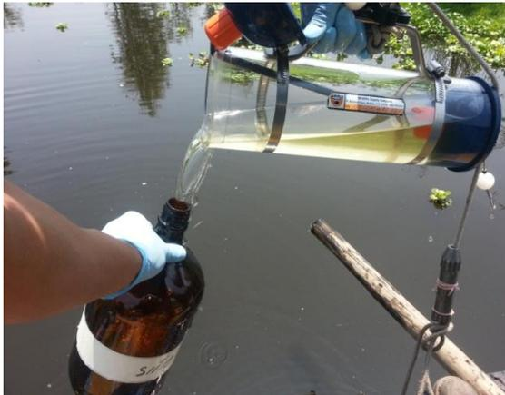
**Figura 3.15.** Vaciado de agua en botellas ámbar.
