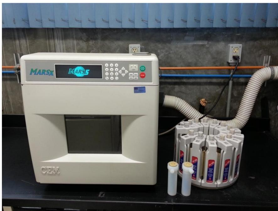
**Figura 3.22.** Tubos de teflón y Horno de Microondas (CEM MARSX).
