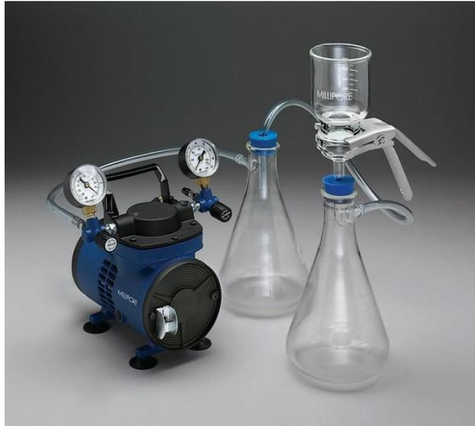
**Figura 3.18.** Sistema de filtración para laboratorio (merckmillipore.com, 2015).
