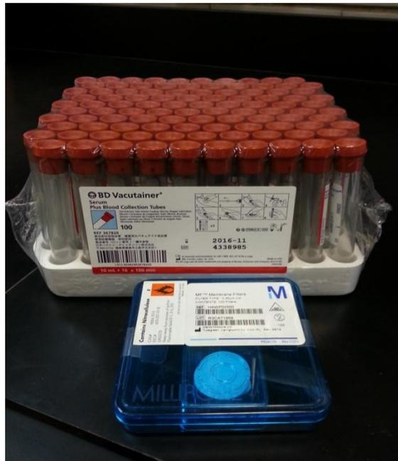
**Figura 3.17.** Vacutainer 10 mL y membranas nitrocelulosa de 0.45 $\mu$ m.
