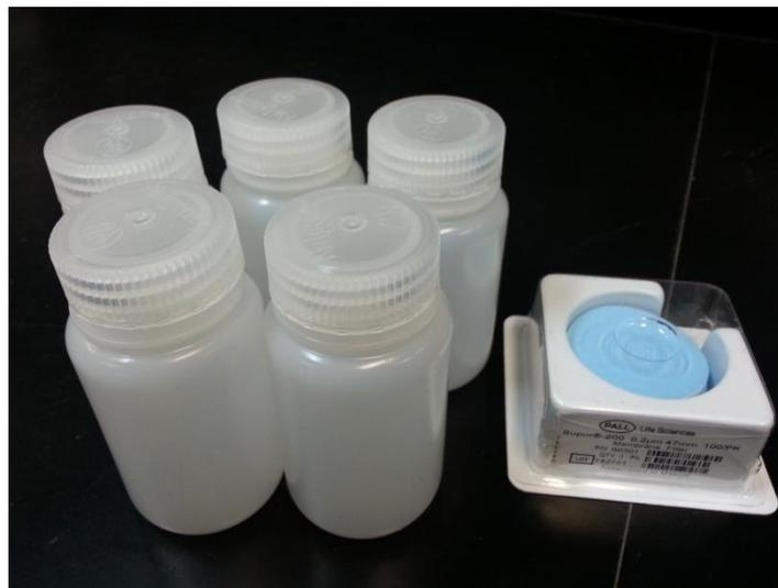
**Figura 3.19.** Botellas de polietileno y membranas de polisulfona de  $0.22\mu\text{m}$ .
