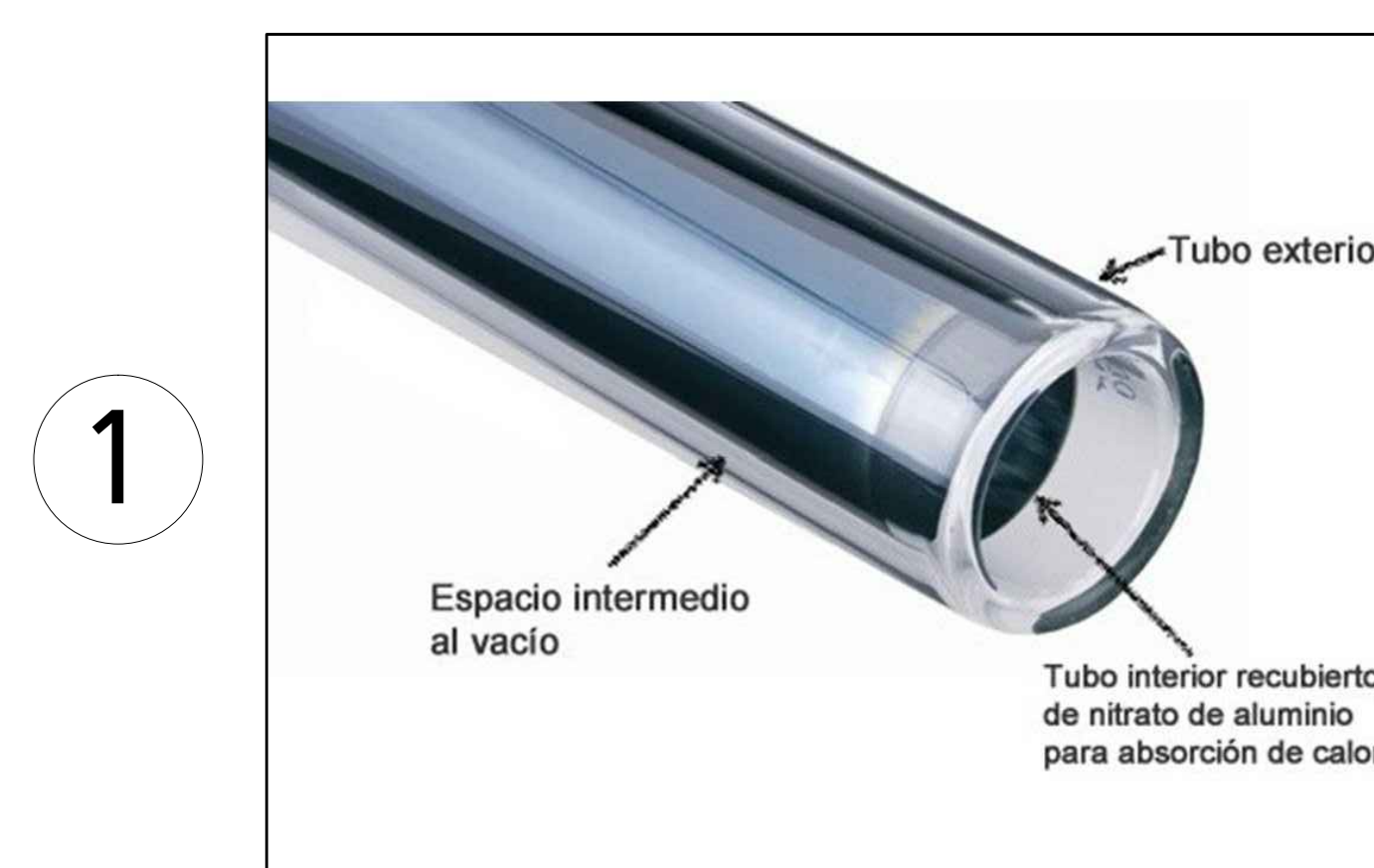
1 TUBO DE VIDRIO AL VACIO CON TRIPLE CAPA DE ABSORCION DE 58mm DE DIAMETRO Y 1800mm DE LARGO CON ARMAZON DE ACER GALVANIZADO MARCA AERO SOLAR MEXICO.
