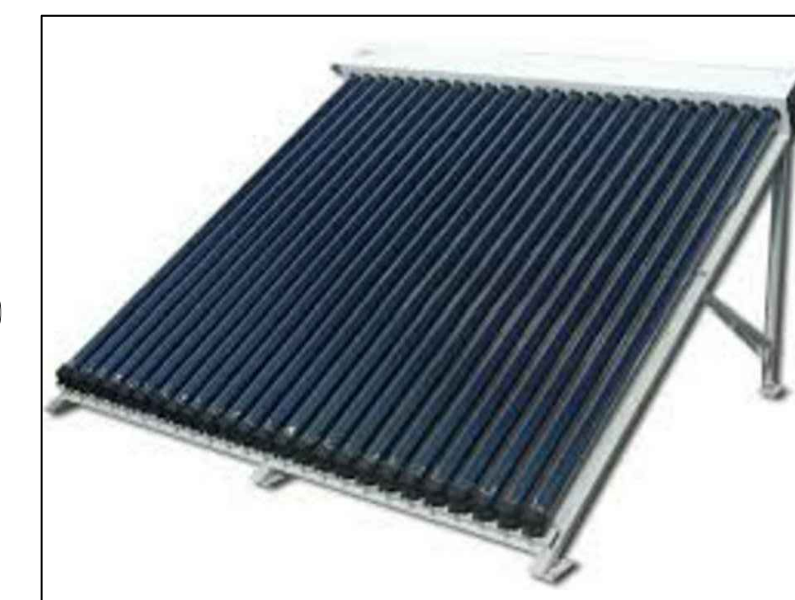
4 CALENTADOR SOLAR NO PRESURIZADO DE 25 TUBO DE VIDRIO AL VACIO CON TRIPLE CAPA DE ABSORCION DE 58mm DE DIAMETRO Y 1800mm DE LARGO CON ARMAZON DE ACER GALVANIZADO MARCA AERO SOLAR MEXICO.
