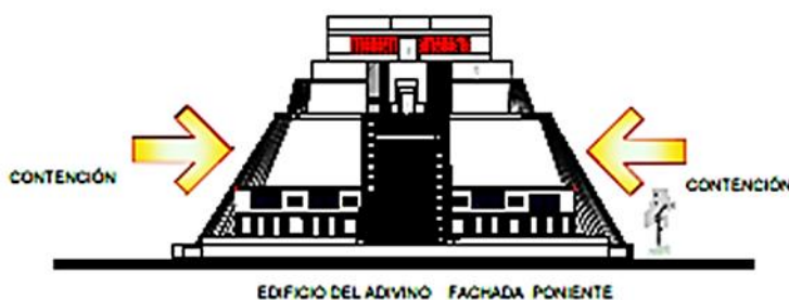
Imagen 198 Cortés Juan. Planta Arquitectónica y fachadas del Edificio del Adivino: mostrando las contenciones y contrafuertes que intervienen en la estabilidad estructural. Planos Arquitectónicos. 2013. Acervo J. Cortés.
