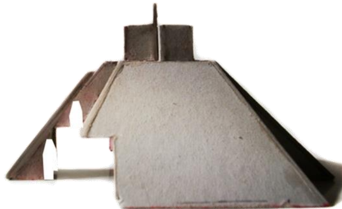
Imagen 222 Cortés Juan. Modelo del Edificio del Adivino de la etapa 2. Sin el Componente uno. La escalera poniente trabaja como contrafuerte. Croquis y Modelos 3D. 2013. Acervo J. Cortés.
