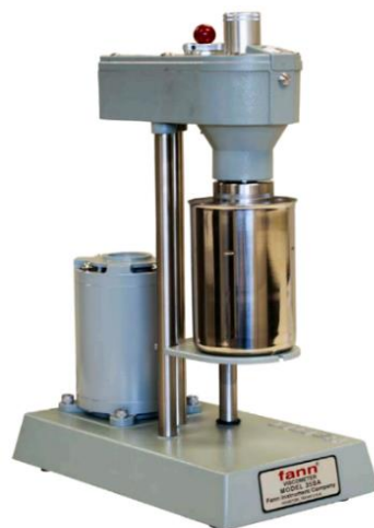
Figura 2. Viscosímetro comercial FANN 35 basado en el flujo de Couette; este dispositivo no permite caracterizar fluidos sometidos a altas presiones y altas temperaturas como las presentes en un pozo real [2].
