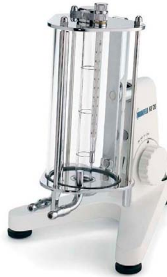
Figura 21. Figura de viscosímetro Haake de caída de bola por plano inclinado [17].
