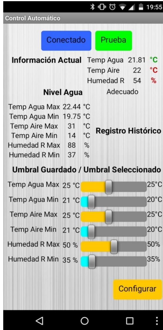
Figura 4.2-1 Vista de la aplicación ejecutada desde el teléfono móvil e interactuando con la tarjeta de desarrollo.
