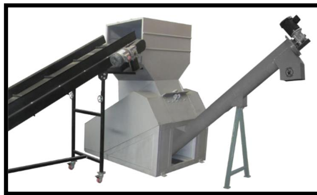
Figura VI.2.2. Equipo de molienda, molino (MO-01). 48
