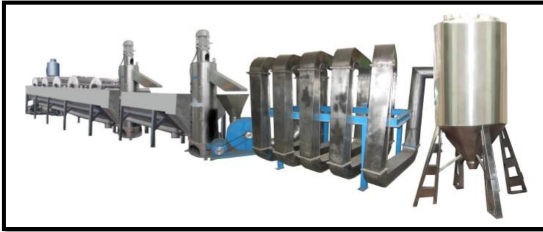
Figura VI.4.2. El proceso de lavado y secado están en un mismo equipo (LYS-01). 50
