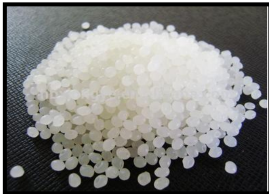
Figura VI.7. Peletizado, el scrap pasa a extruido para salir en forma de "fideos" que son cortados en pellets. 52
