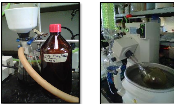
Fig. 17 Proceso de filtración y recuperación de etanol en el rotavapor Pérez, 2013
