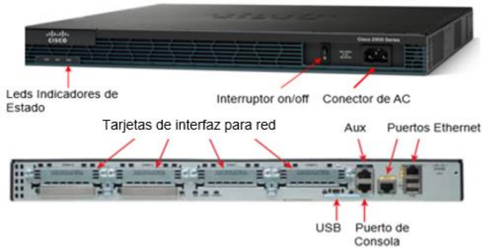
Figura 1.3 Vistas frontal y posterior de un ruteador Cisco 2109
