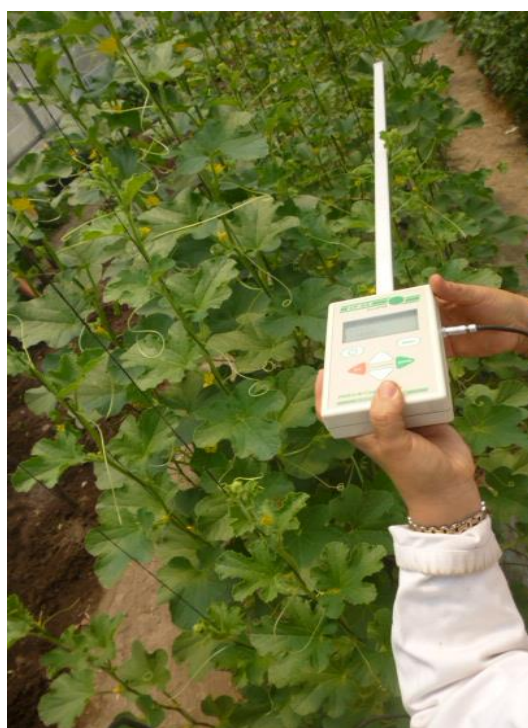
Figura 29. Registro de PAR (Radiación Fotosintéticamente Activa) con ayuda de un ceptómetro.
