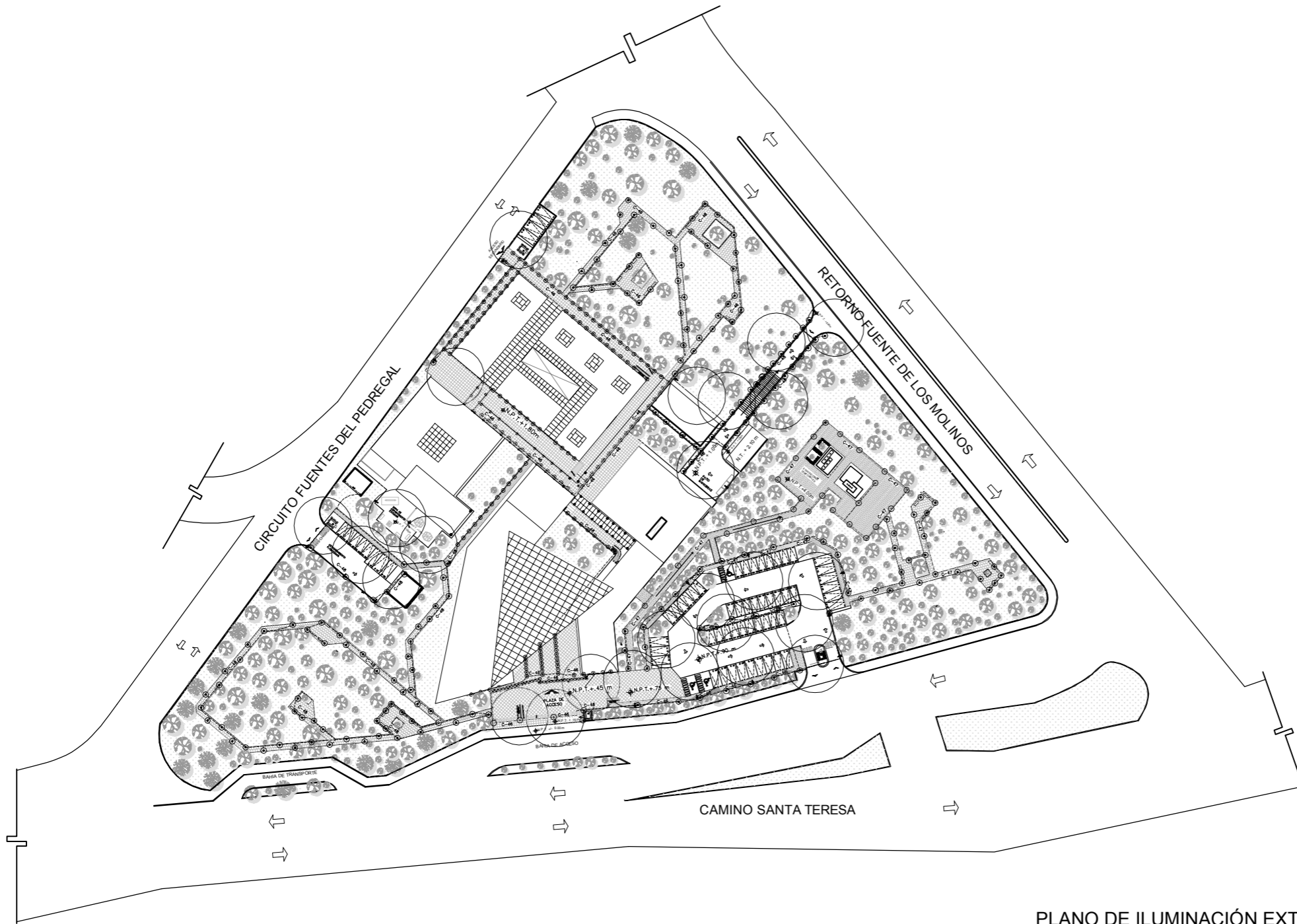
PLANO DE ILUMINACIÓN EXTERIOR
