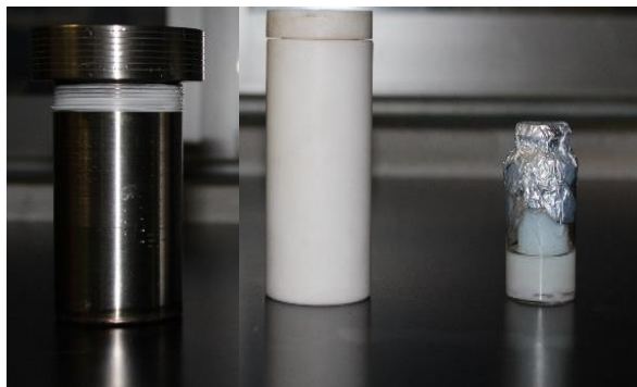
Figura 17. Recipientes utilizados para el tratamiento hidrotermal: reactor de acero inoxidable ASI-316, encamisado de teflón y frasco de vidrio.
