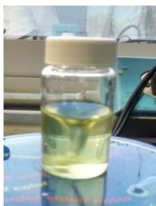
Figura 15. Mezcla homogénea de color amarillo y gelificada de Si/Ti a condiciones normales.
