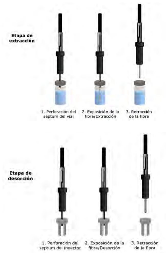
Figura 6. Procedimiento de extracción y desorción [3]
