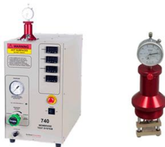
Figura 4.6. Equipo MTS-740 utilizado para la determinación de la conductividad protónica a diferentes temperaturas y humedades relativas.
