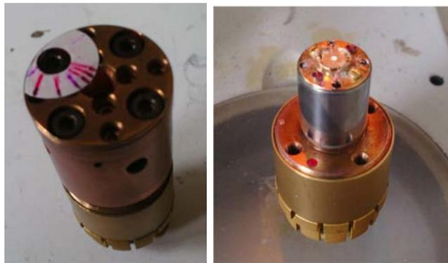
Figura 4.2: Celda de diamantes de la marca Quantum Design. En el lado izquierdo la DAC se encuentra cerrada. La presión se ejerce al girar los tornillos de la parte superior de la DAC. En el lado derecho se observa el interior de la DAC dónde se puede apreciar el gasket montado en la parte superior.
