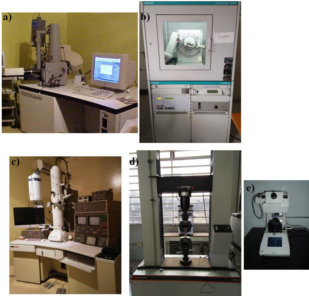
Figura 14. (a) Microscopio electrónico de barrido ( Leica-Stereoscan ); (b) Difractómetro de rayos-x ( Siemens D-5000 ); (c) Microscopio electrónico de transmisión ( JEOL-1200 EX ); (d) Máquina Instron para pruebas mecánicas y; (e) Micro durómetro Matzusawa.
