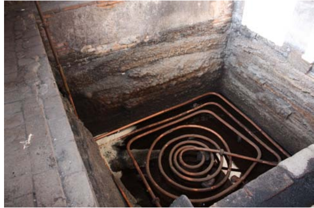
Imagen 4. Tina recolectora del jugo que sueltan las piñas durante el proceso de cocción. En estas tinas se termina de cocer el jugo. Fábrica de mezcal La Pendencia (2013).
