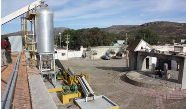
Imagen 6. Autoclave y desmenuzadora o trapiche modernos de la Fábrica de mezcal Ipiña (2013). El equipo moderno conserva la dinámica de producción, no se modifica la arquitectura.
