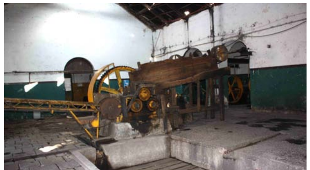
Imagen 8. Desmenuzadora de la fábrica de mezcal La Pendencia. (2013).
