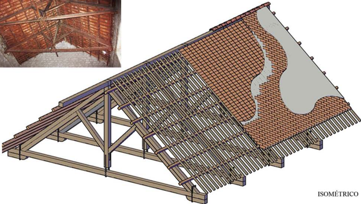
Plano 6. Armadura de la cubierta de madera. Nave de destilación-fábrica de mezcal. La cubierta cubre un claro de 14.50x9.70 m.
