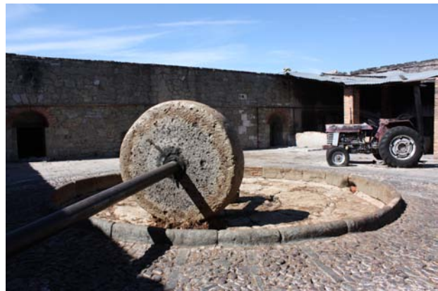
Imagen 5. Las muelas de los molinos son movidas por un tractor en lugar de los burros o bueyes. Fábrica de mezcal Saldaña (2013).
