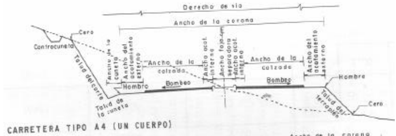
Figura 004.9 Sección transversal en tangente del alineamiento horizontal
