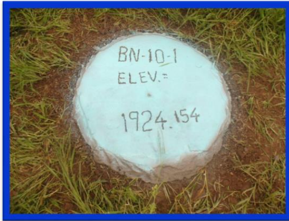
BANCO DE NIVEL BN 10-1 SOBRE MOJONERA A 21.80 m IZQ DEL KM 31+011.50 CON ELEV. PROM. 1924.154
