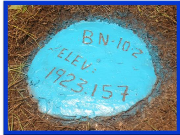
BANCO DE NIVEL BN 10-2 SOBRE MOJONERA A 22.30 m IZQ DEL KM 31+520.00 CON ELEV. PROM. 1923.157
