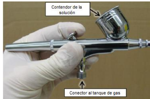
Figura 9.- Atomizador utilizado para la técnica AJS
