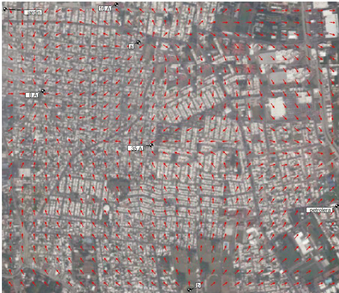
Figura 5.1 Flujo de agua subterránea se observa en la parte Este, la descarga va hacia la costa y en la parte Oeste el efecto en el flujo debido mayor abstracción por los pozos 35 A y 8 A
